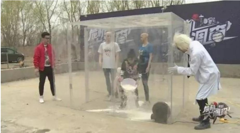
用鼓风机把面粉吹起来，遥控开启电子打火器，结果亚克力箱瞬间爆炸。
