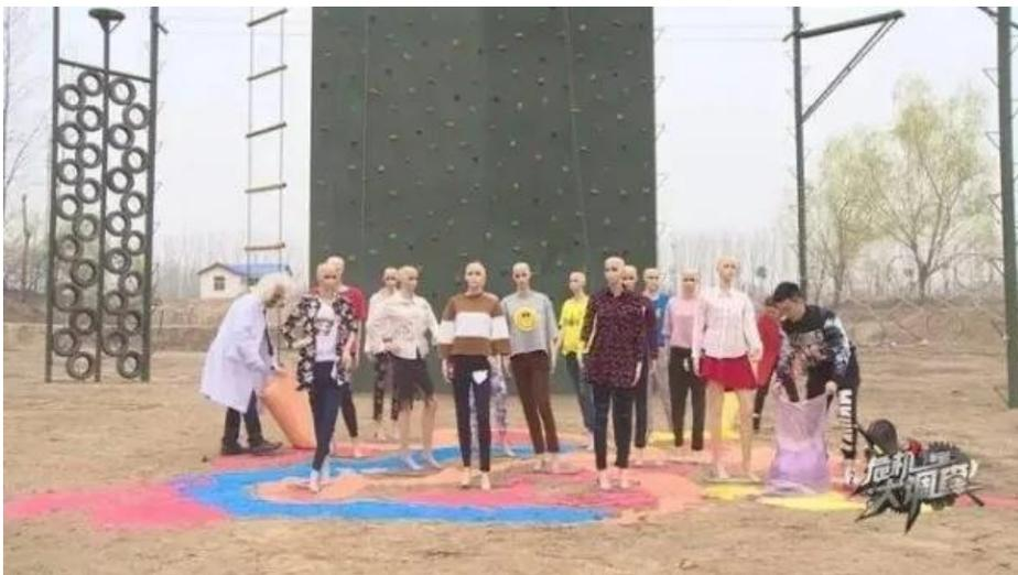
然后，开启工业风扇，使彩色玉米面粉弥漫于整个实验现场，开启电子打火装置。
